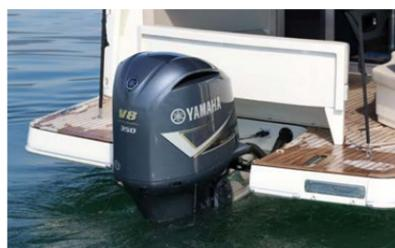
Mit dem Yamaha F350 ist die Spirit 31 HT Outboard hervorragend motorisiert. Knapp 65 km/h sind eine angemessene Spitzengeschwindigkeit. Auf Grund der Konstruktion – der Motor ist nicht am Spiegel, sondern zurückversetzt an einem soliden Gerüst montiert – ist es wichtig, immer auf einen sauberen Trimm zu achten. Ansonsten kann es auf dem Achterdeck nass werden...
